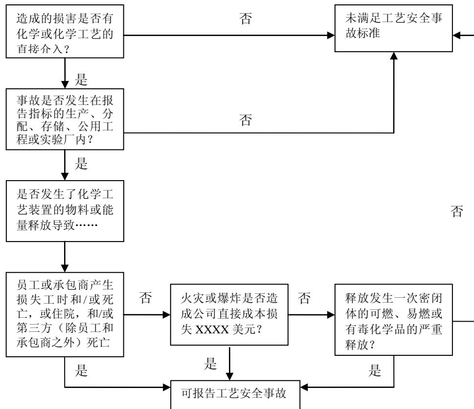
图 A.10 工艺安全事故定义流程表 A.20 工艺事故分类
