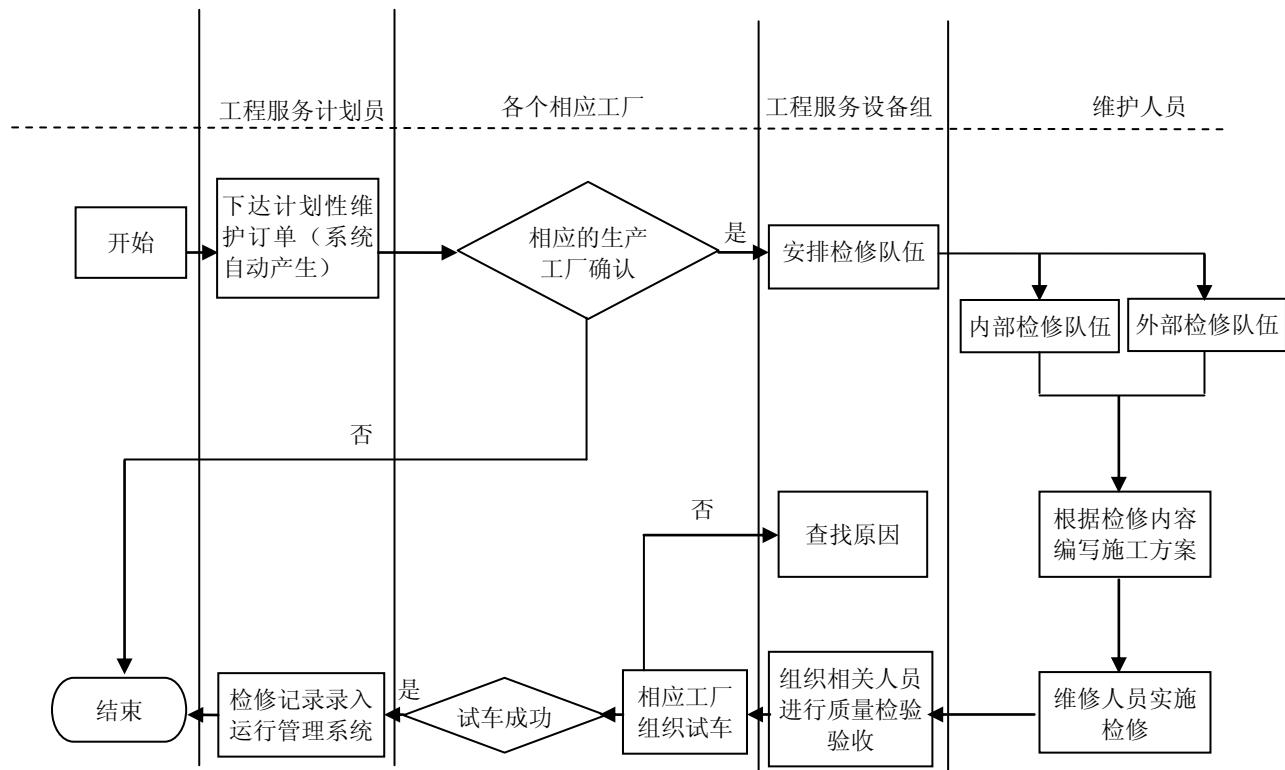
图 A.7 维修工作流程
