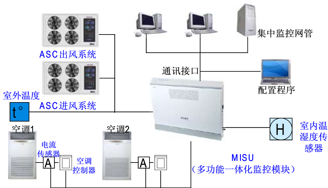
图表 16: 智能机房温控系统
