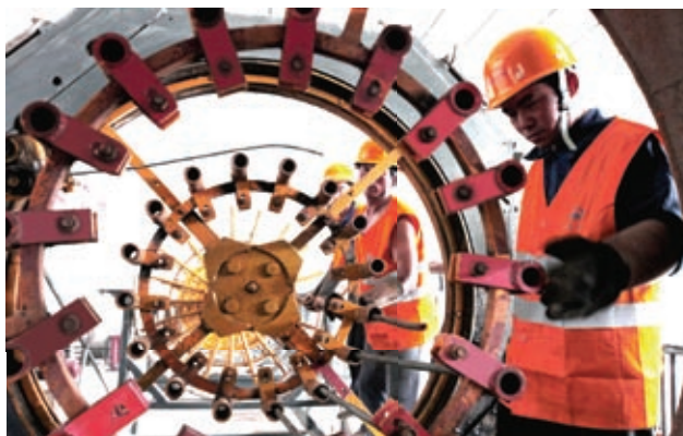
改进后的钢筋笼滚焊机工效提高四倍
