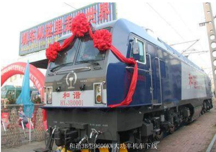
和谐3B型9600KW大功率机车下线
