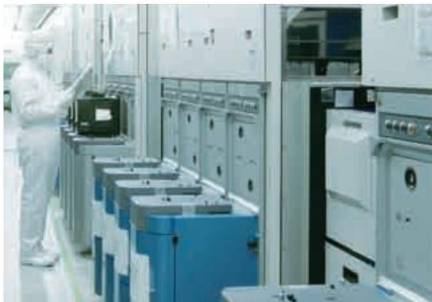
半导体工厂的洁净室，采用局部空调方式控制能耗。
