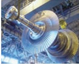
**高效火力发电用汽轮机**
