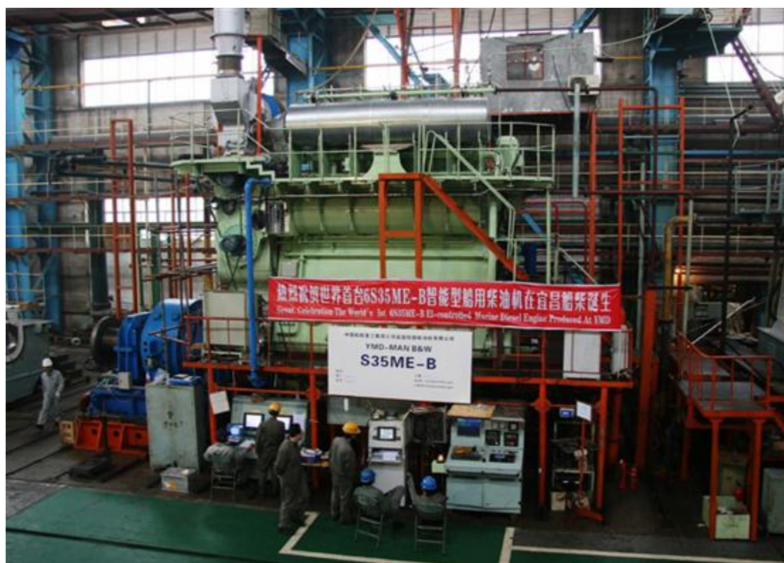
世界首台 MAN B&W 6S35ME-B 智能型二冲程船用低速柴油机
